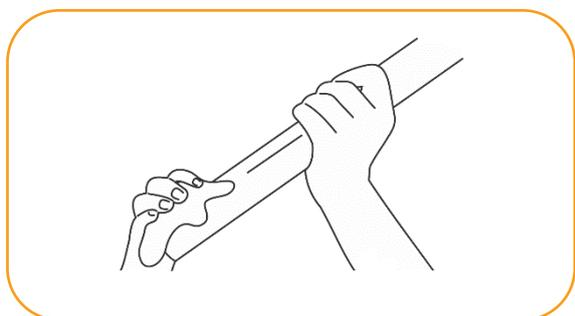
3. Corte um trecho de tubo com o mesmo comprimento do tubo danificado que foi retirado. Lembre-se de retirar as rebarbas das extremidades e de limpá-lo.
