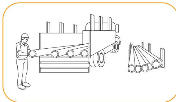
O local de armazenamento deve ser plano e bem nivelado, para evitar deformações permanentes nos tubos.
