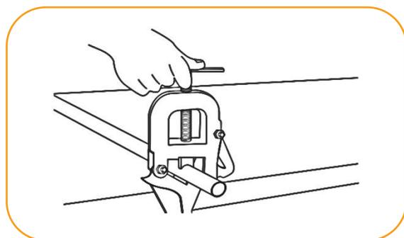
3. Monte a tarraxa observando a colocação correta do cossinete, coloque-a no tubo fazendo uma pressão com uma das mãos e girando a ferramenta no sentido horário. Atente para que o cossinete esteja alinhado ao eixo do tubo.
