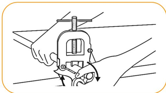
6. Retire o tubo da morsa e conecte-o com a conexão. O aperto da rosca deve ser feito de forma manual. A forma de rosquear é simples, porém muito importante. Quando bem-feita, preserva a tubulação, evita vazamentos e não causa danos à rosca. Importante: não utilize ferramentas no aperto de juntas roscáveis.
