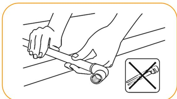
7. A instalação está pronta, libere o fluxo de água para verificar a estanqueidade da junta roscável.
