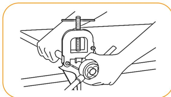
**Importante:** A abertura de rosca nos tubos deve ser feita com tarraxas especiais para PVC rígido, garantindo assim que a espessura resultante no tubo permaneça, resistindo aos limites de pressão admissíveis por norma.
