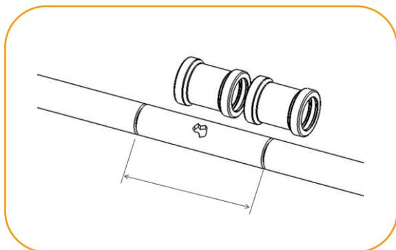
2. Retire as rebarbas do tubo a ser reparado e limpe as superfícies externas com um pano limpo e Solução Limpadora.
