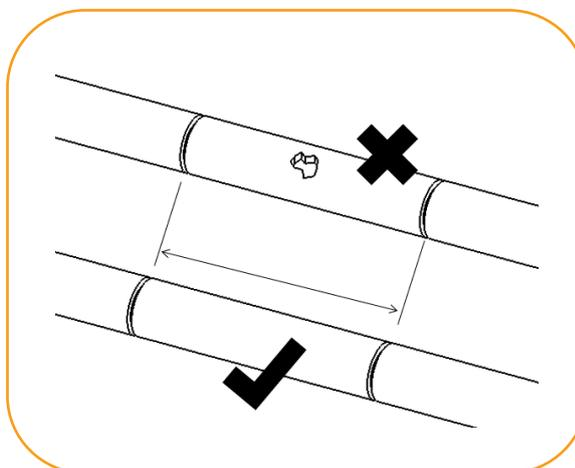
4. Instale as duas luvas de correr na extremidade do tubo de reparo, com uso de Pasta Lubrificante. Após, coloque o novo trecho com as luvas de correr no trecho a ser reparado.
