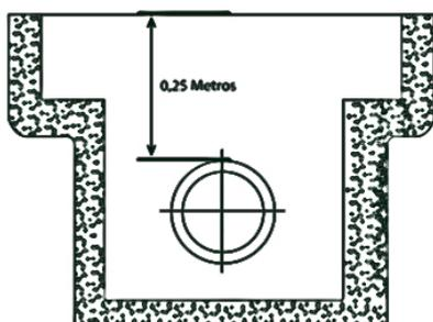
2° Em instalações externas sujeita a tráfego de veículos leves, os eletrodutos de PVC devem ser enterrados a uma profundidade de no mínimo 0,45 metros.
