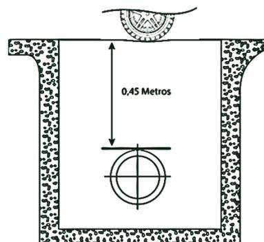
3° Em instalações externas sujeitas a trânsito de veículos pesados, os eletrodutos de PVC devem ser enterrados a uma profundidade superior a 0,45 metros, protegidos por placa de concreto, ou envelopados.
