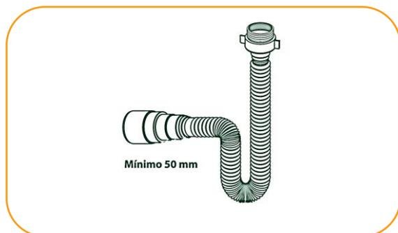
4° Verifique o diâmetro do ponto de esgoto e encaixe o terminal luneta no diâmetro correspondente.
