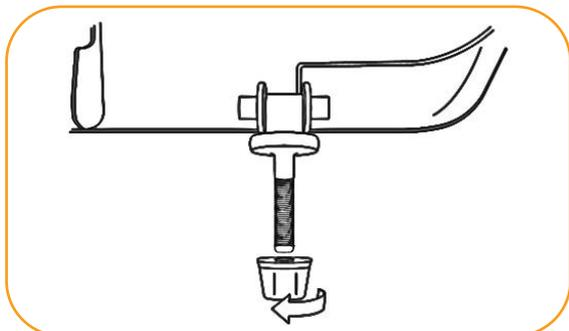
2° Encaixe o assento na louça sanitária, certificando que os dois parafusos entrem no furo de forma nivelada;
