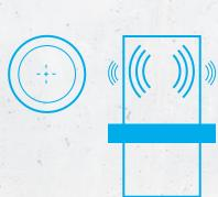
Tubazioni caricate mineralmente (a bassa rumorosità) – Wavin AS+ (densità = 1,90kg/cm³; spessore parete = 5,3 mm)
