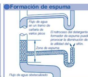
HepVO® ha sido probado y resiste una presión negativa de hasta 0.05 bar. Esto excede la resistencia de una trampa regular con sello de agua de 75mm de profundidad y provee una barrera contra el escape de malos olores, mientras también resuelve el problema de sello por sifonaje, desplazamiento, acción capilar, evaporación o por presencia de espuma.
