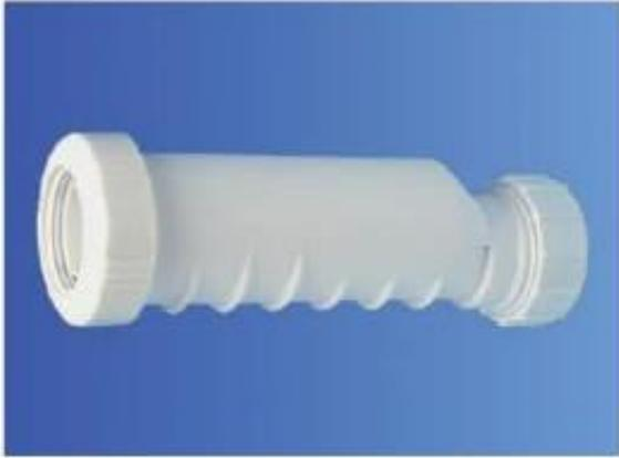
HepVO® es una válvula auto-sellante y la mejor alternativa a la trampa tradicional, en particular cuando el sello de agua se ve comprometido, por ejemplo, por la evaporación debido al clima cálido o al poco uso. Su diseño lineal compacto y la opción de instalarlo horizontal o verticalmente, puede ahorrar mucho espacio. La válvula también puede reducir el requerimiento de tubería de ventilación en algunos aparatos.
