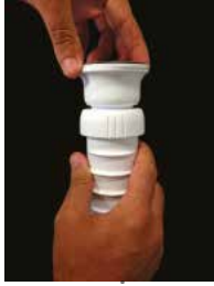
4- Lavabo süzgecinin Hepvo® diyaframını üst rakoru ağzına saat yönünde çevirerek monte ediniz. Rakoru çökerek contayı sıkıştırınız. d32'lik Hepvo® bağlantısı için kit içerisinde yer alan conta ayrıca kullanılmaktadır.
