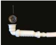
5- Lavabo monte etmek için süzgeç üstü vidasını söküp, metal süzgeç ile plastik taban arasında lavabo kalacak şekilde monte ediniz.
