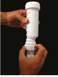
3- Rakor dışını çevirerek diyafram ile birleştiriniz. Körük hortumunu çökerek montajın düzgün olup olmadığını kontrol ediniz.
