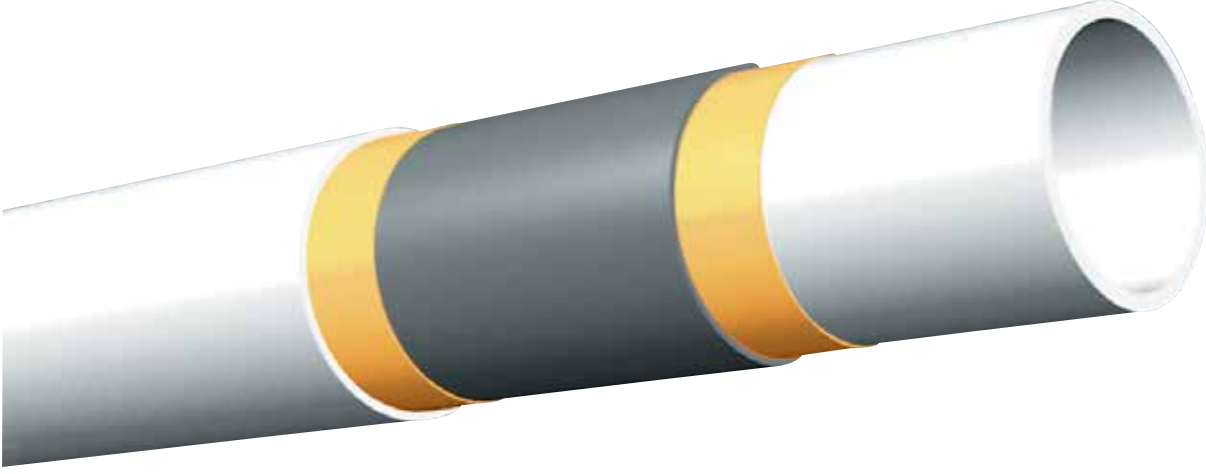
Şekil 2: Çok katmanlı metal plastik boru yapısı
