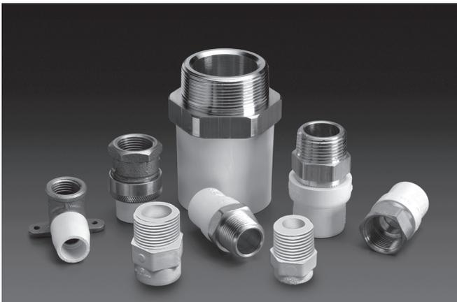
Des raccords de transition sont disponibles pour le raccordement vers d'autres matériaux des valves et des accessoires et devront être utilisés pour tous les raccordements de tuyauterie pour l'eau chaude. Pour les raccordements à l'eau froide, des adaptateurs mâles filetés en PVC-C peuvent être utilisés. Ils ne sont pas recommandés pour une utilisation avec de l'eau chaude, car de grandes fluctuations de température peuvent entraîner une fuite goutte à goutte.
